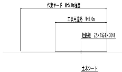
※作業ヤードは、工事用道路部 (W=3.0m) および作業員の通行、資材、残土等の仮置きスペースとして5.0m程度となるよう借地する。
